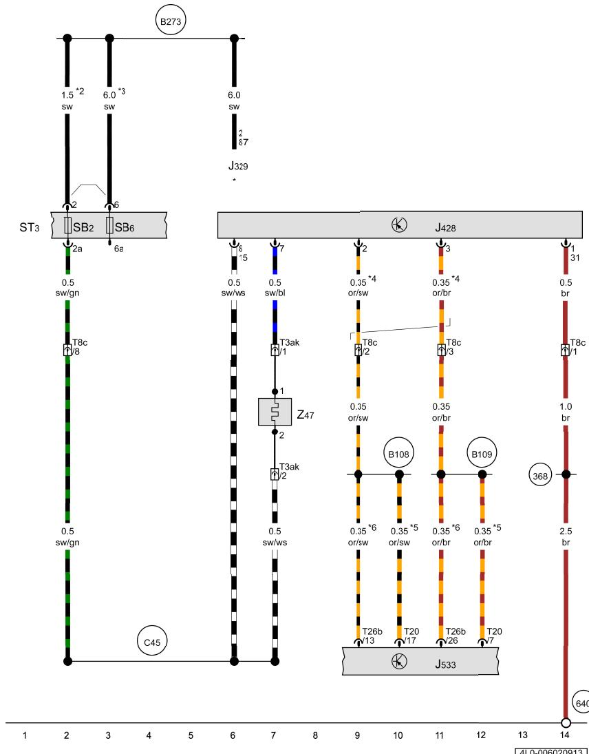
车距调节控制单元, 数据总线诊断接口, 车距控制装置传感器的加热装置
